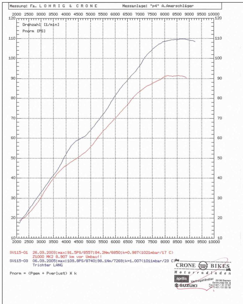
**Die rote Kurve ist die Eingangsmessung, die blaue die nach dem zweiten Tuning (Diese, und alle weiteren Kurven, zeigen die Kupplungsleistung, gemessen nach DIN auf Amerschläger p4)**
