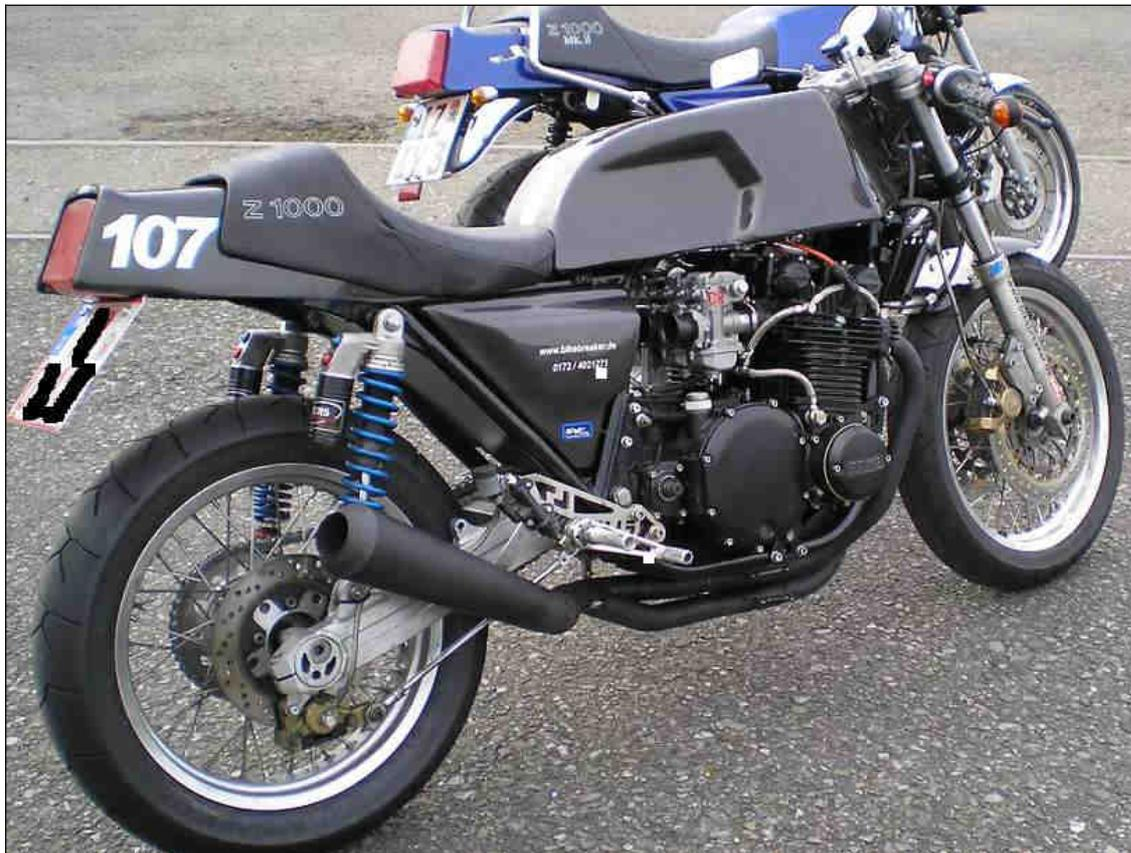
***Roberts Umbau auf Basis der Z1000. Tank, Bürzel und Seitendeckel aus Karbonfaser. Weitere edle Zutaten an allen Ecken und Enden. Ein ganz übler Graus für die Original-Fraktion***
